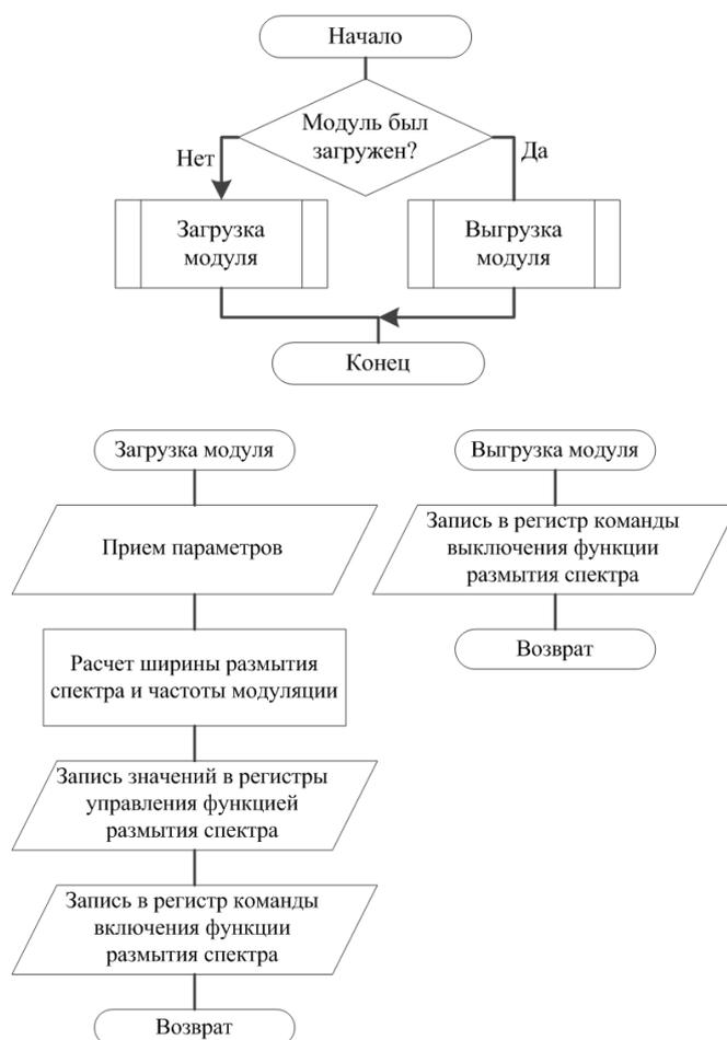
Рис. 3. Алгоритм управления функцией размытия спектра
